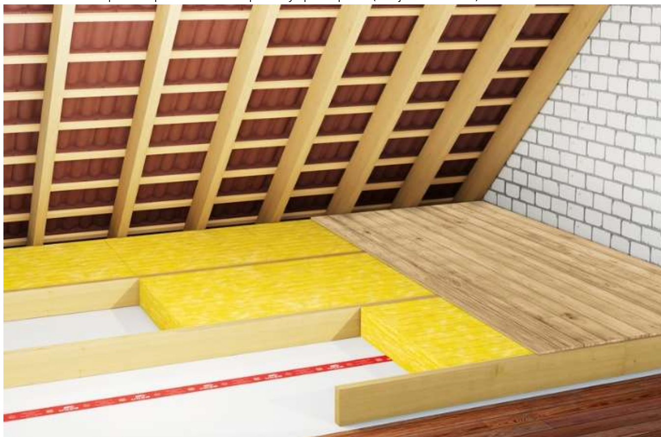
Obrázek č. 4.9.3: Zateplení stropu minerální vlnou pod nevytápěnou půdou (Zdroj: izolace-info.cz)
